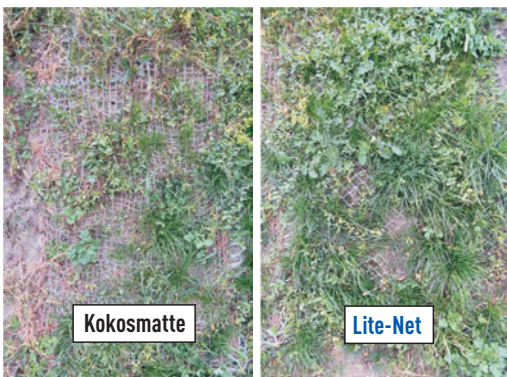
Bewuchs von Kokosmatte (links) und Lite-Net (rechts) nach 3 Monaten extremer Trockenheit
