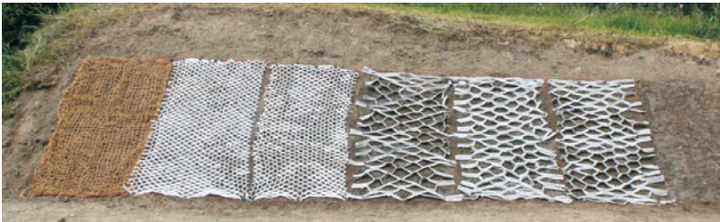
Versuchsböschung nach der Hydrasaat
