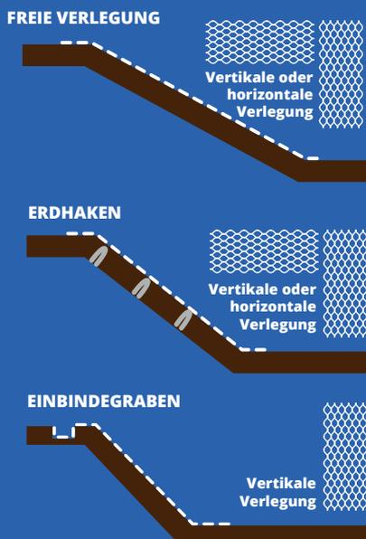
Bei Neigungen ab ca. 30° befestigen sie das LITE-NET mit Erdhaken, ab ca. 45° mittels Einbindegraben.
